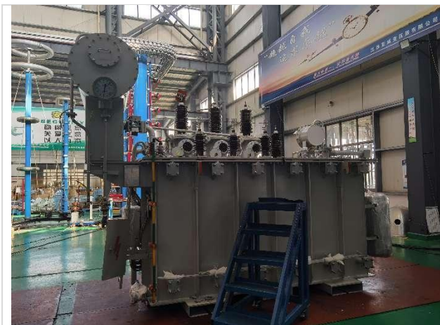
Applied voltage test for SZ-10MVA/35/10KV: H.V.~L.V. & Earth
